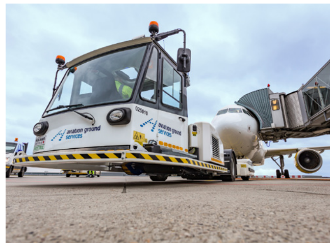
Pushback-Fahrzeug mit elektrischem Antrieb
